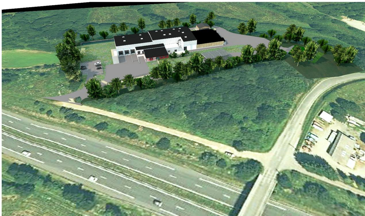
La volumétrie des toitures à deux pentes évite la mise en œuvre d'un complexe d'étanchéité et permet la pose de panneaux photovoltaïques sur leur versant Sud sans complément de structure.
